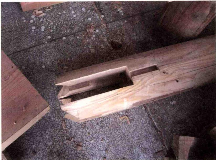
图3-15 加工的柱构件
